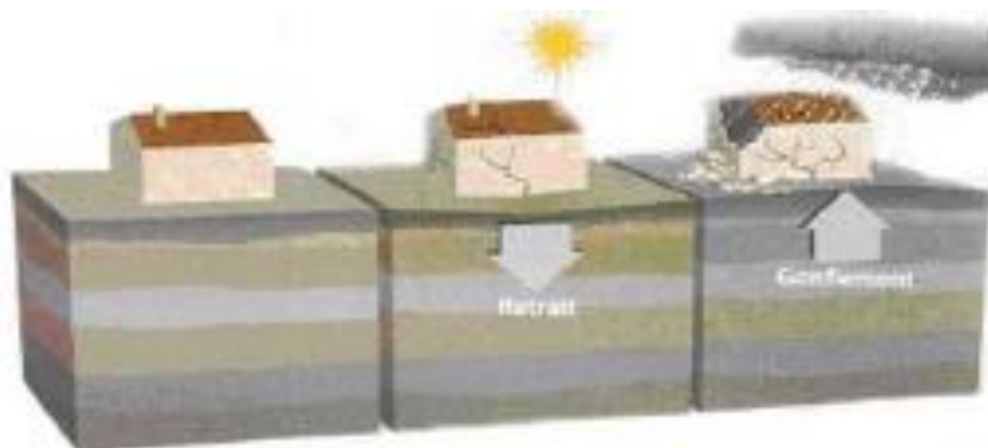
Figure 1 : Le phénomène de retrait-gonflement des argiles illustré (Source : BRGM)
